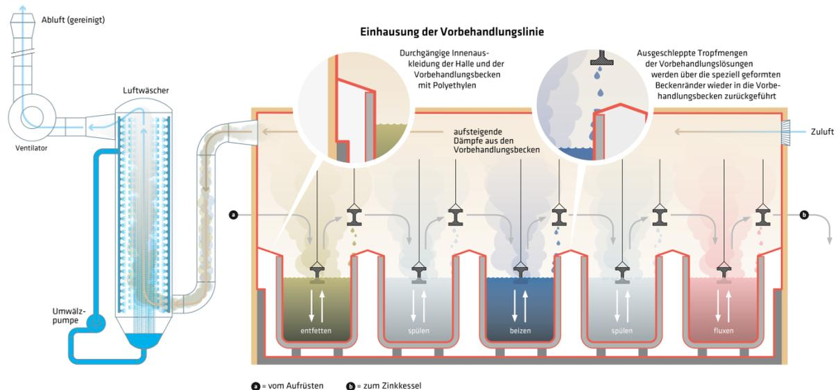
Einhausungen des Verzinkungskessels mit Absaugung und Filteranlage sind ebenfalls schon lange Wiegel-Standard. Inzwischen haben unsere Neuanlagen ein technisches und Umweltschutzniveau erreicht, das als vorbildlich in der Branche zu bezeichnen ist.
