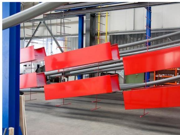
Wiegel Duplex-System: Feuerverzinkung plus Pulverbeschichtung aus einer Hand. Der nachhaltigste Korrosionsschutz jetzt auch in allen Farben des Regenbogens. Die nachhaltige Schutzwirkung der Feuerverzinkung in Kombination mit der Schutzwirkung der Pulverbeschichtung. Optimaler Schutz hat noch nie besser ausgesehen. Auch hier steht Qualität an erster Stelle durch unser Managementsystem nach DIN EN ISO 9001.
